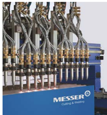
Pode ser equipada com até 18 maçaricos de oxicorte ou até três fontes plasma. Aplicação especial para corte de tiras, com posicionamento automático lateral das tochas.
