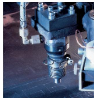
O marcador a punção pneumático faz gravação permanente, bem como linhas e pontos nitidos, e a marcação de centro é perfeita para guiar uma furação. É capaz de marcar com nitidez letras, números e outros tipos, inclusive em superfícies oxidadas ou com carepa de laminação. Possui velocidade de 3 m/min, controle de altura automático e sensor de colisão, o que evita danos ao marcador e a outros equipamentos.
