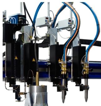
A possibilidade de combinar ferramentas permite que a máquina seja equipada com qualquer fonte plasma, oxicorte e marcação.
