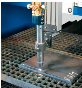
No maçarico de oxicorte Alfa Torch a pressão e a vazão dos gases são reguladas automaticamente pelo OmniFlow via CNC. A tocha possui acendimento automático interno, controle de altura magnético patenteado pela Messer, válvulas de segurança antirretrocesso e sensor de colisão que evita danos ao equipamento. A substituição dos consumíveis é feita manualmente, de forma rápida e sem a necessidade de usar ferramentas. A capacidade de perfuração é de 130 mm, podendo cortar espessuras de até 300 mm.
