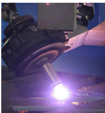
Corte a plasma com chanfrador automatizado Skew Rotator. Giro infinito para chanfros com espessura de até 40 mm.
